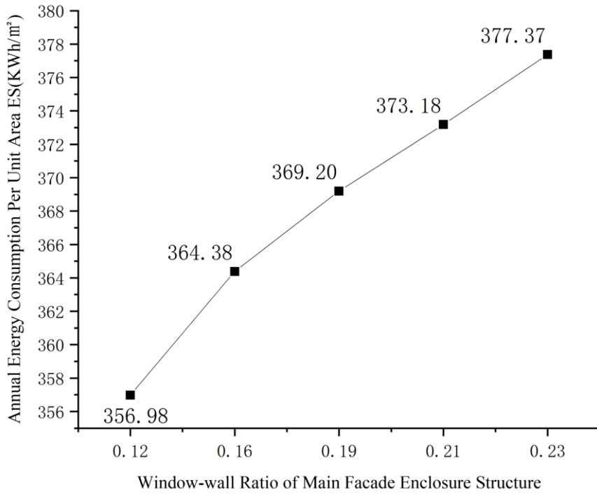
(d) Window-wall ratio of main facade enclosure structure
